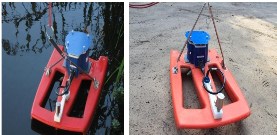
Fot. 3., 4. Sonda ADCP wykorzystywana w badaniach
